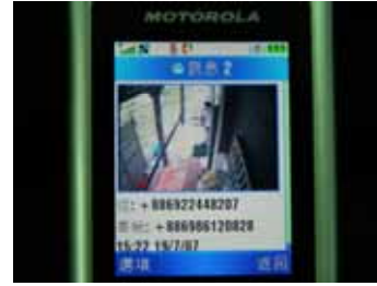
圖 7 行動電話接收移動物件的 MMS 告警
